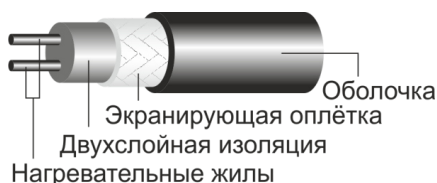
Рисунок 3 – Устройство нагревательного провода.
