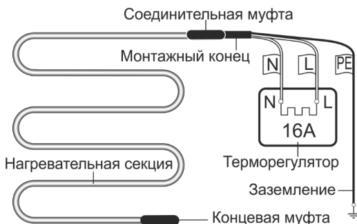
Рисунок 6 – Подключение теплого пола к терморегулятору.
